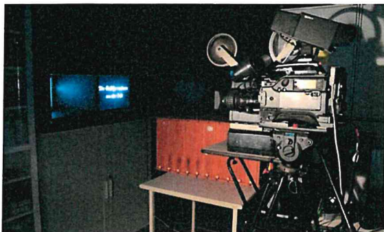
Abfilmung und Umwandlung eines analog projizierten Bildes in ein digitales Format
